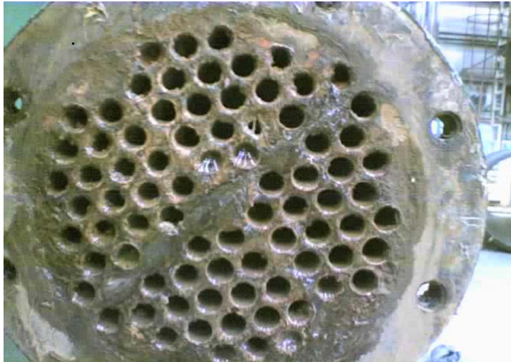
Vista 1.- Intercambiador de calor libre de incrustaciones a 30 días de la experiencia sin uso de ningún químico.
