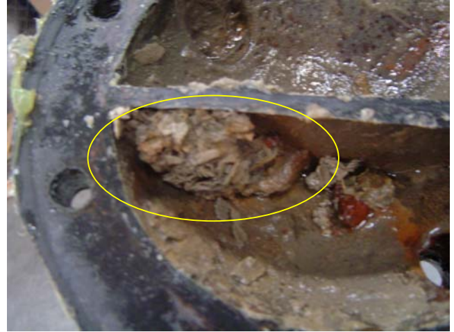
Vista 2.- Parte de las incrustaciones removidas depositadas en la tapa del intercambiador máquina 3.
