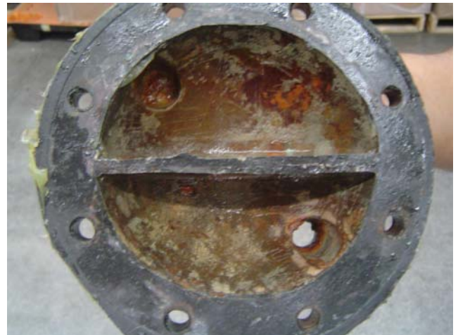
Vista 4.- Tapa de intercambiador máquina 3 limpiado únicamente con agua.
