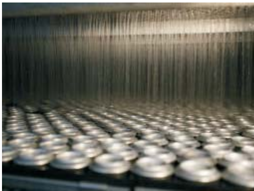
Tunnel di pastorizzazione ANK 2-4% per ora in zone 1-8, 2-9, 3-10.
