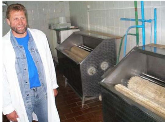
Trattamento finale, pulizia e risciacquo delle unità
